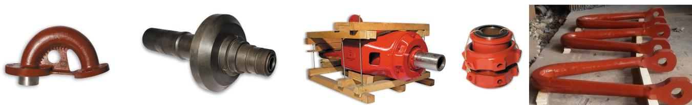
Вертлюги УВ-250 и УВ-320 входят в комплект буровых установок для эксплуатационного и глубокого разведочного бурения нефтяных и газовых скважин. Вертлюги предназначены для поддержания на весу бурильного инструмента, а так же для герметизации канала промывочной жидкости в месте сопряжения неподвижных деталей с вращающейся колонной бурильных труб.
