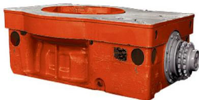
Роторы Р-560 и Р-700 предназначены для выполнения следующих операций при бурении скважин: передачи вращения колонне бурильных и обсадных труб при свинчивании и развинчивании, а в комплекте с клиньями ПКР для механизированного захвата и освобождения колонны бурильных труб при спуско-подъемных операциях и спуске обсадной колонны; поддержания на весу на клиньях или на элеваторе колонны бурильных и обсадных труб.
